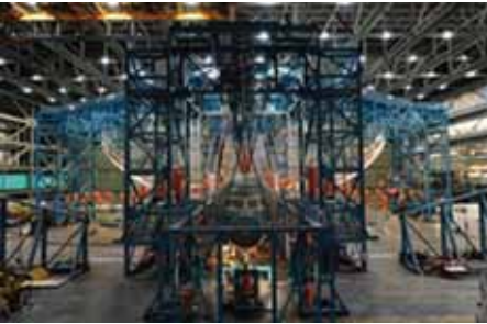
Şekil 8: Hava Aracı Quasi-statik ve Ömür Testleri
