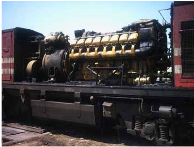
Şekil 48 TÜRASAŞ DE24000 Lokomotiflere Güç Veren Yerli TLM Motorlar
