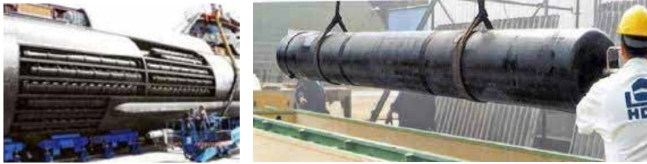
Şekil 16 Metal Hidrat Hidrojen Tankları, U212
