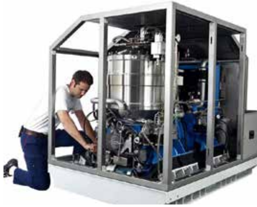
Şekil 18 Gotland Sınıfı Denizaltıların 75kW'lık Kockum Stirling Motoru
