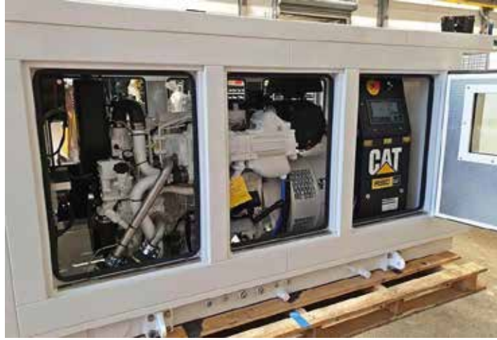
Şekil 11 Dizel Jeneratör Seti (CAT C7.1 dizel motor)
