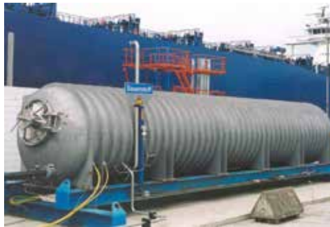
Şekil 17 HBT Sistemi Sıvı Oksijen (LOX) Tankı, U212
