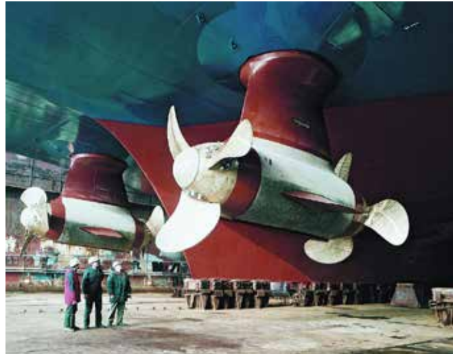
Şekil 9 Her Biri 11 MW, Elektrik Tahrikli Azimut Pervaneleri
