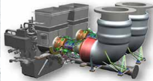
Şekil 4 Kore PKX Botları ve LM500 Gaz Türbini Modülü
