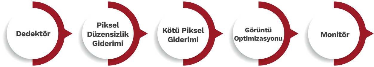
Şekil 32. Kızılötesi Verinin Görüntüye Dönüşümü İçin Gerekli İşlemler
